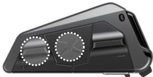
Im ausgeschalteten Zustand die PLUS & CENTER Taste drücken und gedrückt halten, bis die LED blau und rot blinkt (ca. 6 Sek.).
