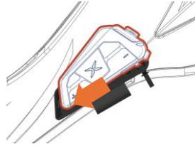
Richten sie den Controller an den Führungsschienen aus und schieben ihn nach unten bis er hörbar mit einem „Klick“ einrastet. Dadurch wird eine ordnungsgemäße Befestigung gewährleistet.
